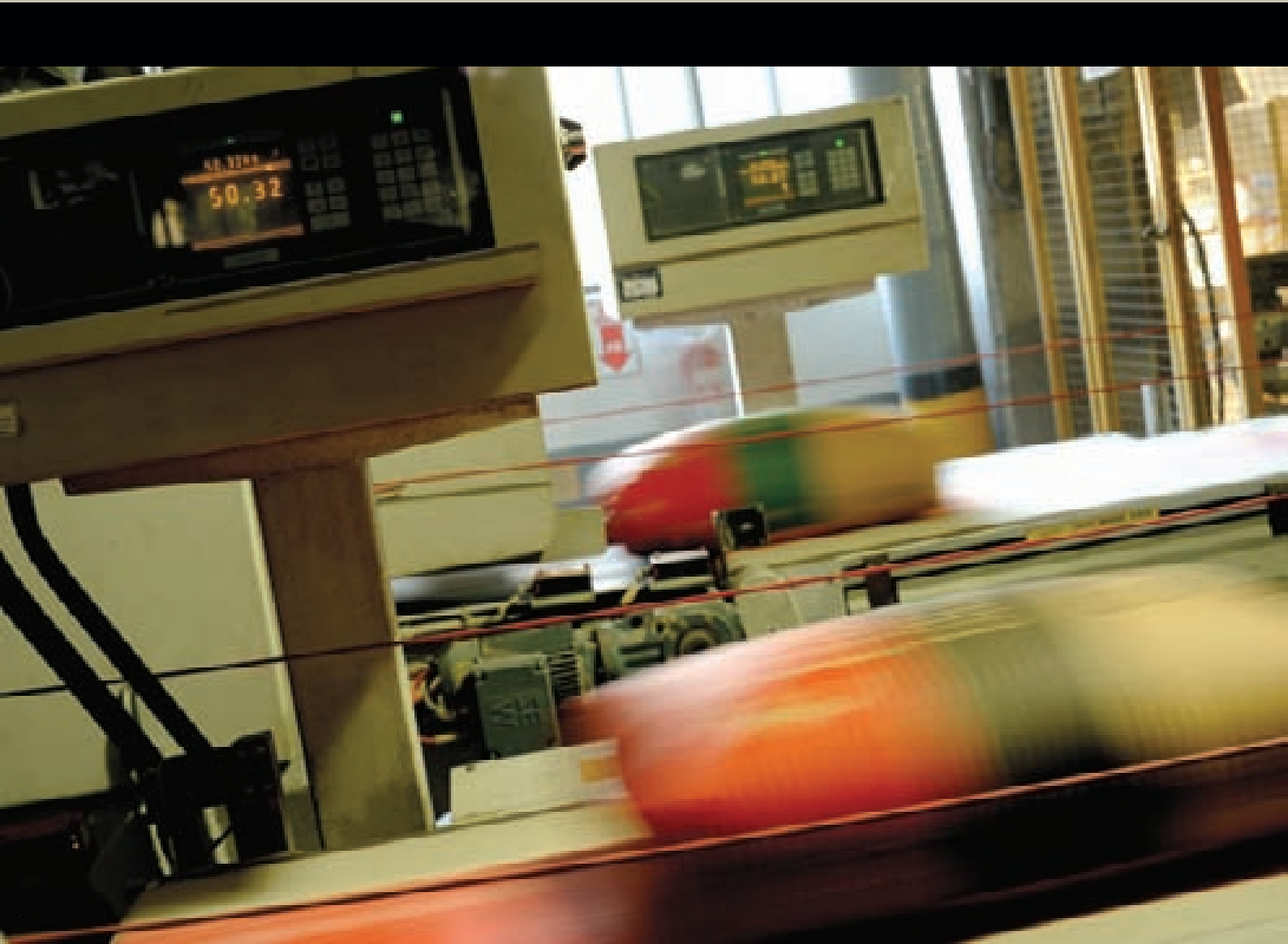
Pesagem automática e controle de peso dos sacos de cimento. Automatic weighing and control of sacks of cement.
