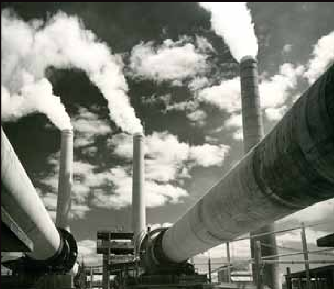
Antiga fábrica de cimento via úmida, comum na primeira metade do século XX, com elevado consumo de combustíveis. Old cement factory using the wet process, common in the first half of the 20th century, with high fuel consumption.
